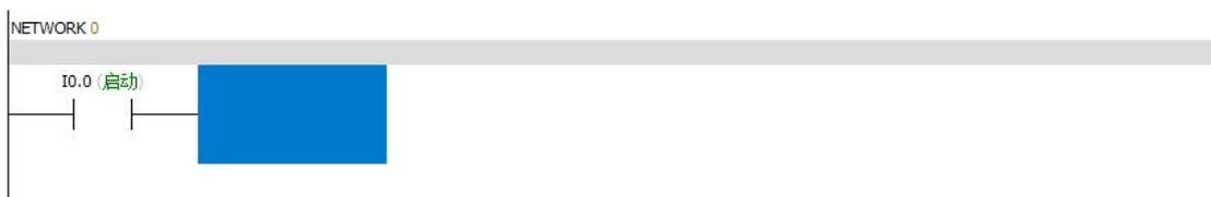
4、将光标移至 I0.0 触点右侧，输入<L> <D> <I> <空格符> <I> <0> <.> <1> <Enter>
