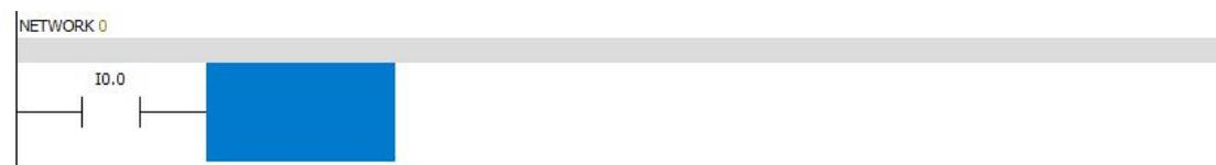
2、光标移至 I0.0 常开触点右侧输入<M> <V> <I> <空格符> <2> <空格符> <R> <W> <0> <Enter>;
