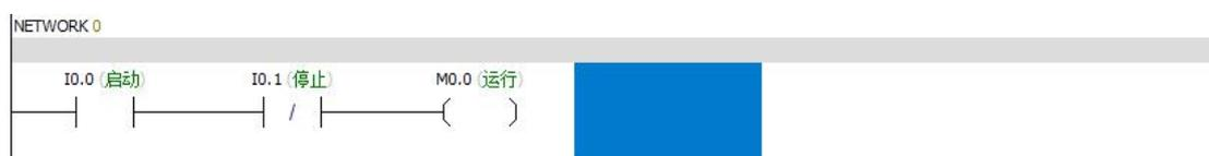
6、将光标移至 I0.0 触点下方，输入<O> <空格符> <M> <0> <.> <0> <Enter>
