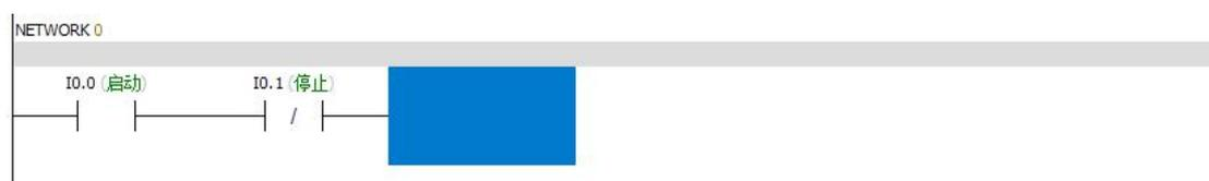
5、将光标移至 I0.1 触点右侧，输入<=> <空格符> <M> <0> <.> <0> <Enter>
