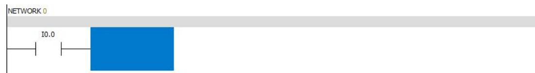
2、光标移至 I0.0 常开触点右侧输入<T><O><N><空格符><1><0><0><空格符><Q><0><.><0><Enter>;
