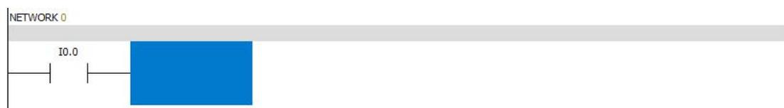
2、光标移至 I0.0 常开触点右侧输入<+> <I> <空格符> <R> <W> <0> <空格符> <R> <W> <1> <空格符> <R> <W> <2> <Enter >;
